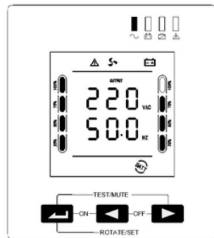
دکمه های پنل دستگاه های رک مونت
