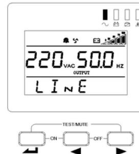
دکمه های پنل دستگاه های مدل ایستاده
